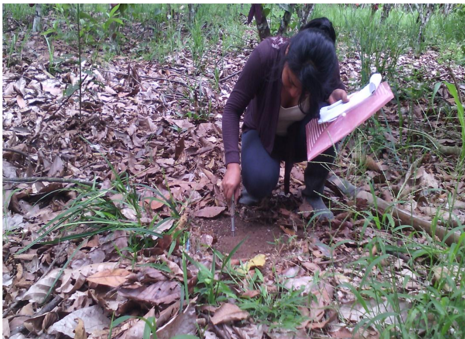
Figura 21. Medición de la resistencia a la penetración del suelo
