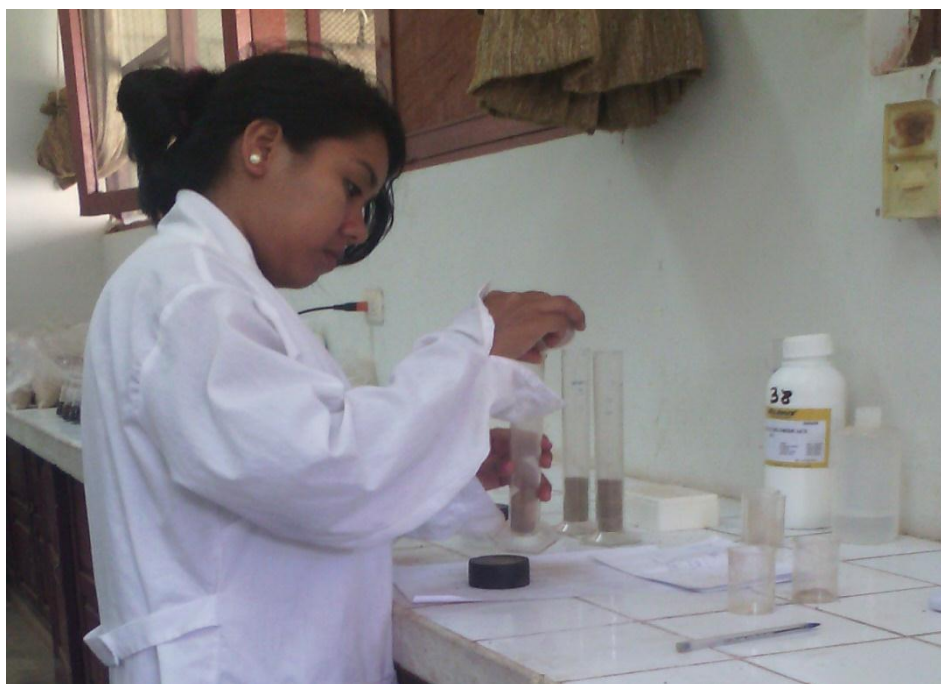
Figura 23. Medición de la densidad aparente del suelo
