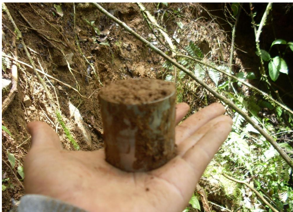
Figura 12. Cilindros muestreados para determinar la humedad relativa del suelo.
