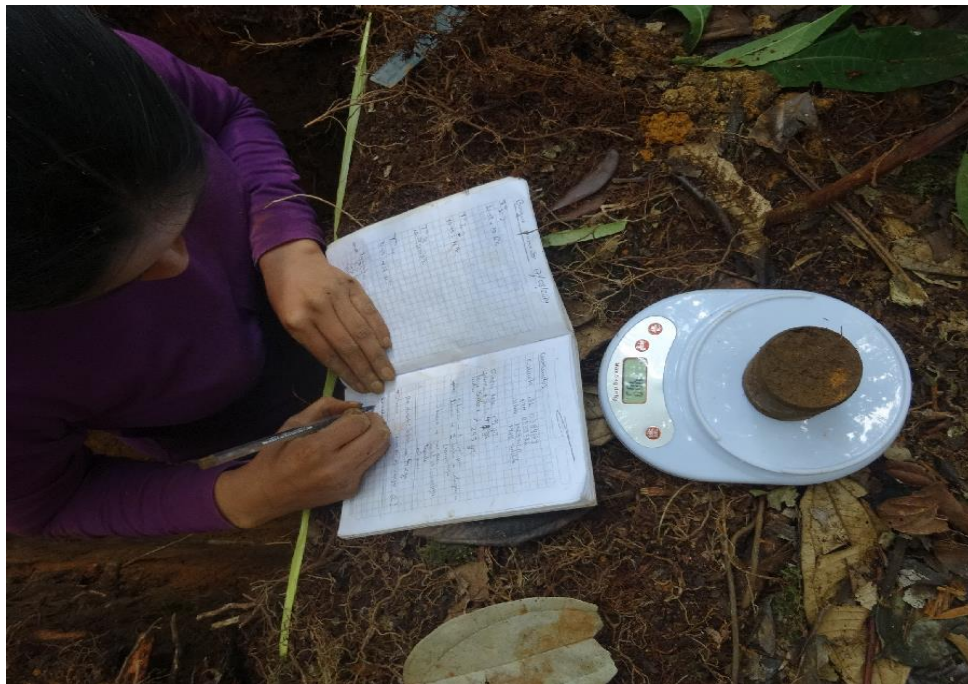
Figura 21. Realizando el peso la muestra húmeda en el campo, para determinar la Da. Del suelo.
