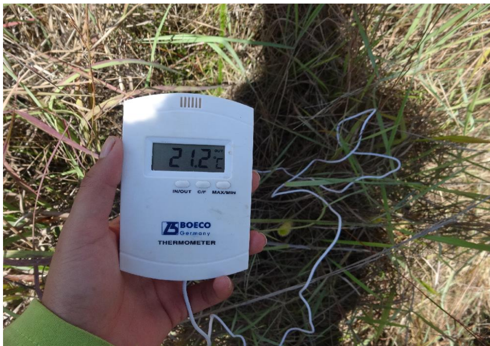
Figura 22. Monitoreando la temperatura del suelo.
