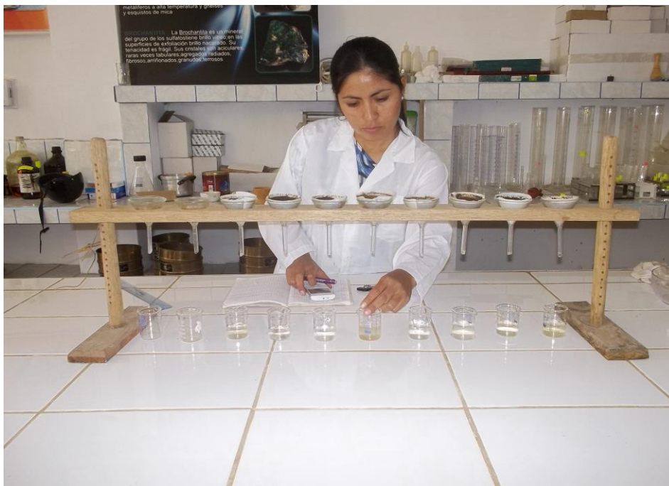
Figura 26. Realizando pruebas de capacidad máxima de retención de agua del suelo.
