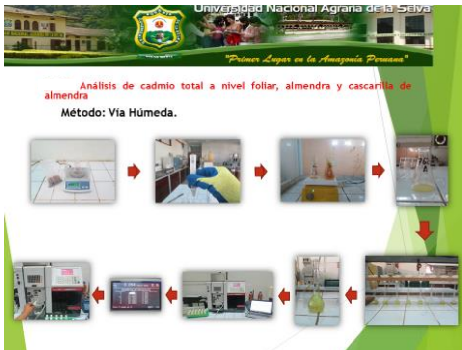
Figura 10. Proceso de análisis de cadmio total a nivel de almendra y hojas.
