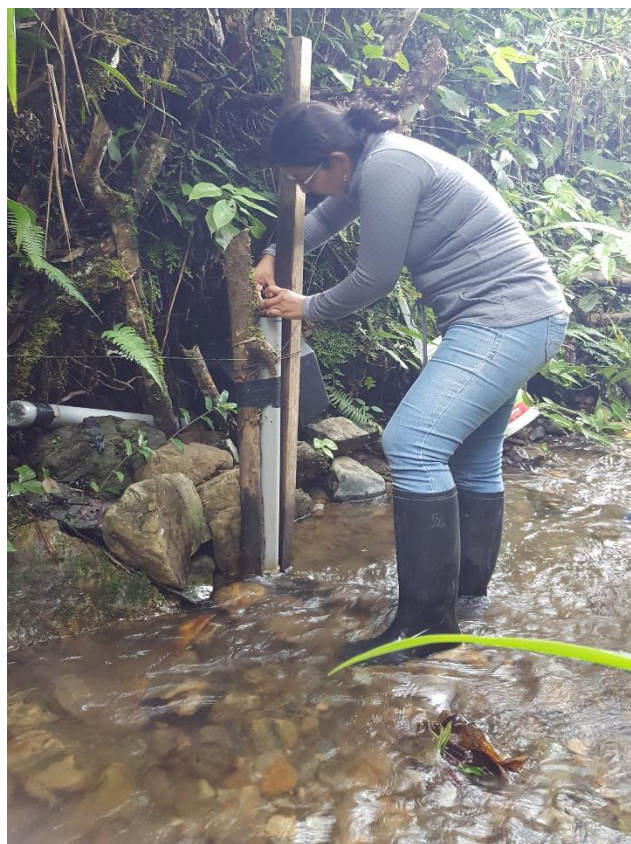
Figura 27. Retirando la memoria interna para la descarga de datos
