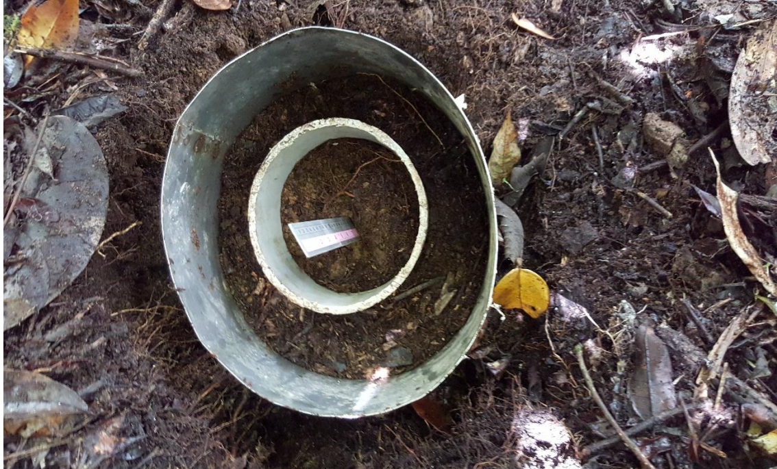
Figura 29. Colocación de los anillos de doble entrada para medir la infiltración
