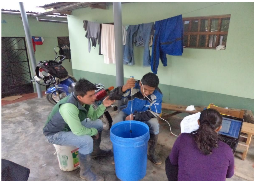
Figura 25. Realizando la calibración del Sensor de nivel de agua
