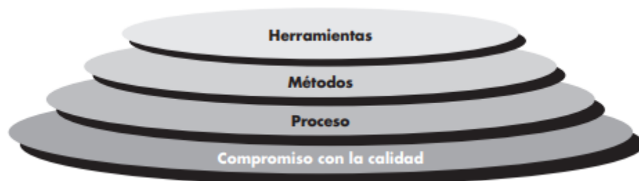
Figura 1. Capas de la Ingeniería de Software
