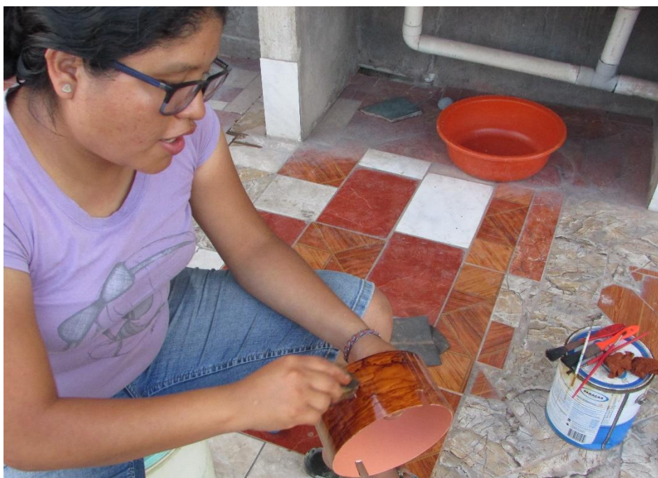
Figura 25. Construcción del contenedor para el muestreo de \text{SO}_2
