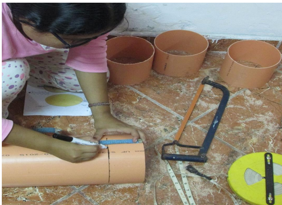
Figura 24. Medición del contenedor para protección de los tubos
