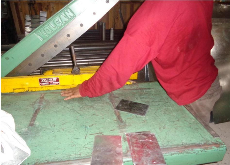
Figura 30. Cortado de electrodos de acero galvanizado y aluminio
