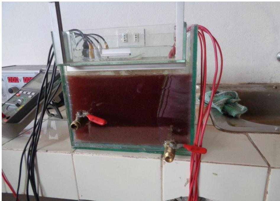
Figura 9. Proceso de electrocoagulación a 1A con 5 minutos
