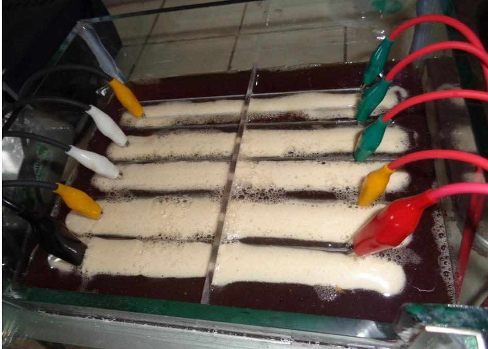
Figura 31. Inicio del proceso de electrocoagulación
