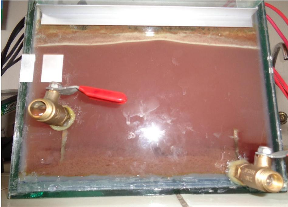
Figura 10. Proceso de electrocoagulación a 1.5A con 5 minutos
