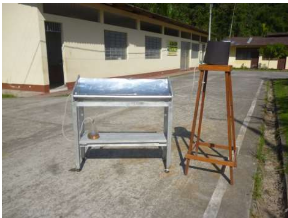
Figura 24. Colector parabólico solar en funcionamiento.
