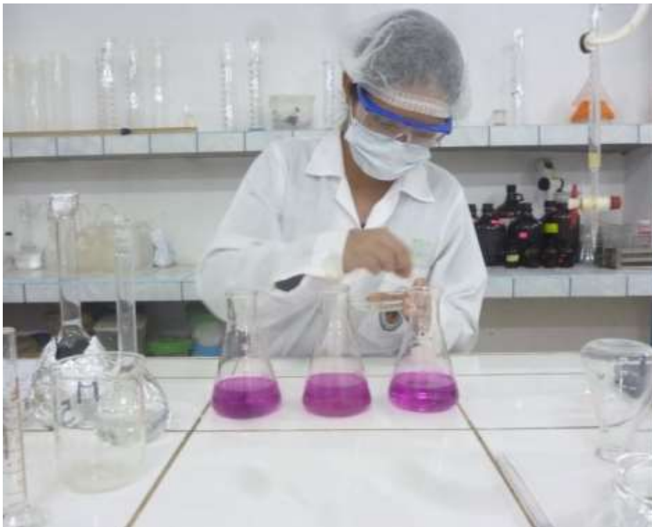
Figura 27. Agregado de perlas de vidrio para la determinación del índice de oxidabilidad al permanganato.
