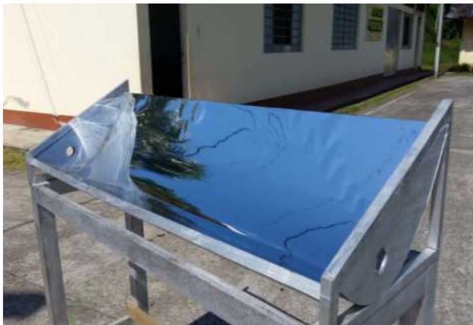
Figura 23. Estructura del colector parabólico solar.
