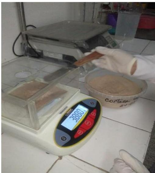
Foto 3. Pesaje de pulverizados de corteza
