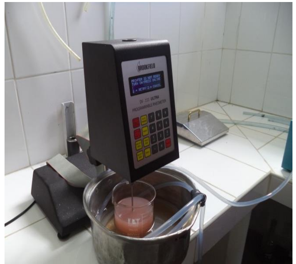
Evaluación Reológica de los prototipos de bebida de linaza saborizada con limón y camu camu
