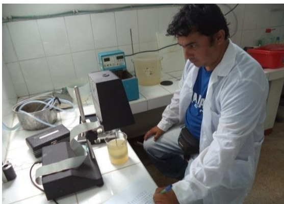
Evaluación Reológica de los prototipos de bebida de linaza saborizada con limón y camu camu
