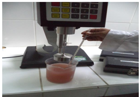
Evaluación Reológica de los prototipos de bebida de linaza saborizada con limón y camu camu
