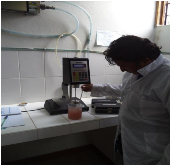
Evaluación Reológica de los prototipos de bebida de linaza saborizada con limón y camu camu
