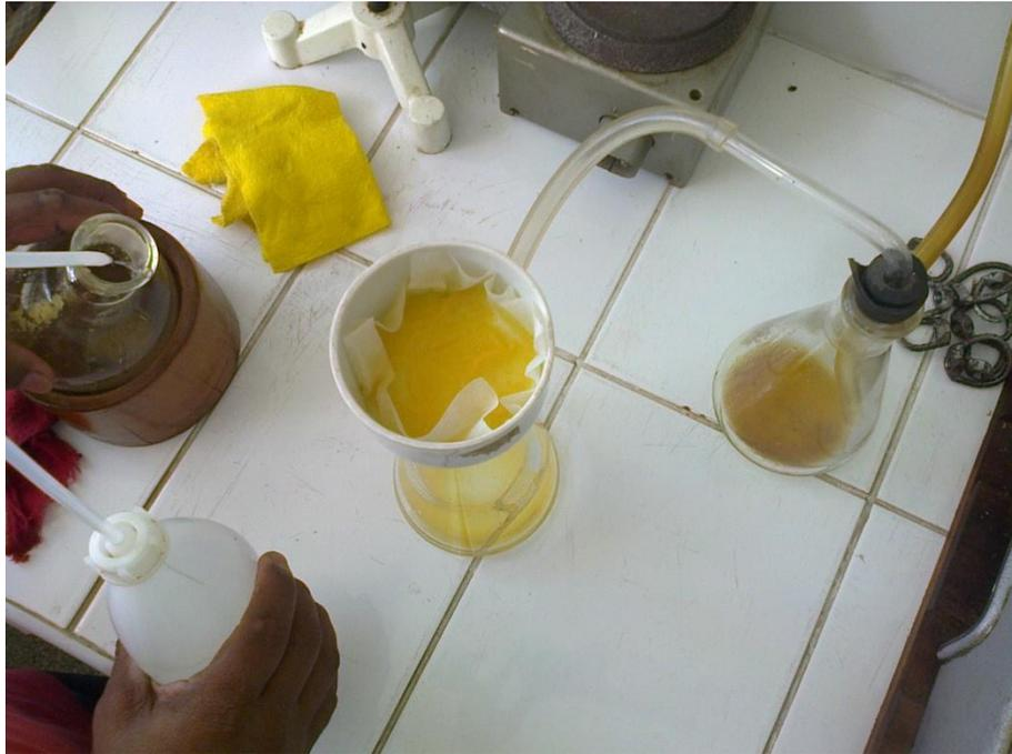
Figura 26. Se decantó el líquido sobrenadante sobre el crisol filtrante con la ayuda de la bomba al vacío
