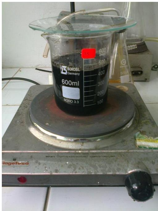
Figura 28. Muestra con ácido sulfúrico en ebullición, para determinar lignina
