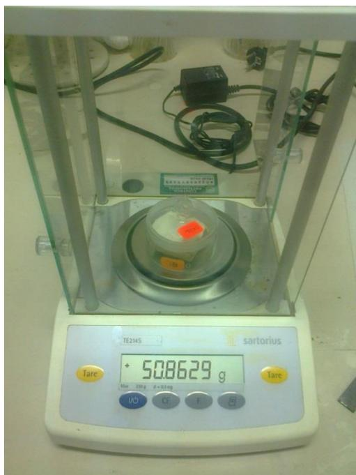
Figura 30. Muestra secada en estufa y pesada, determinación de lignina
