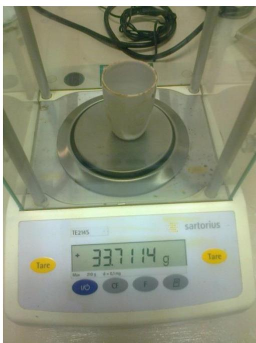
Figura 31. Muestra luego de ser incinerada, para determinar lignina
