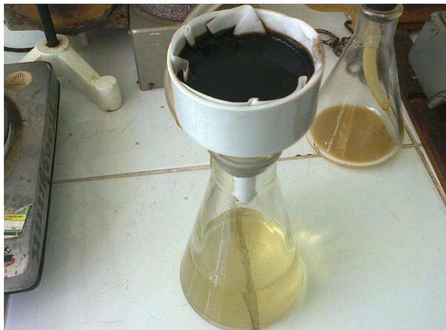
Figura 29. Muestras con ácido sulfúrico para filtrar, determinación de lignina
