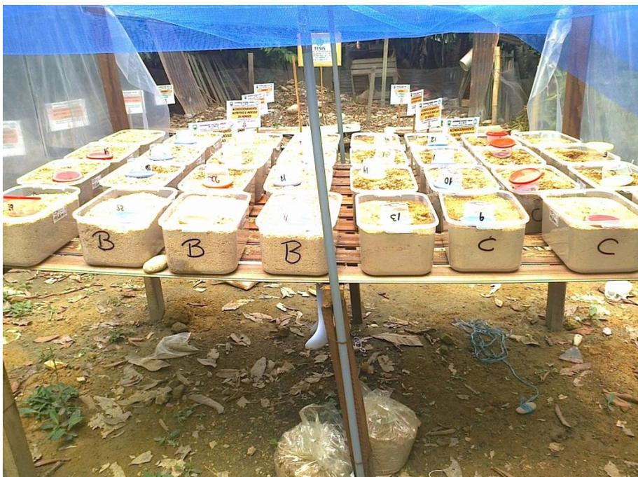
Figura 17. Aserrín colocado en envases de 28 x 12 x 18 cm. rotulados con el nombre de la especie y las condiciones del tratamiento
