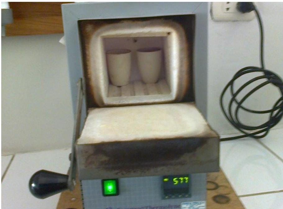
Figura 27. Crisol con celulosa en la mufla hasta llevarlo a cenizas y anotar el peso de las cenizas
