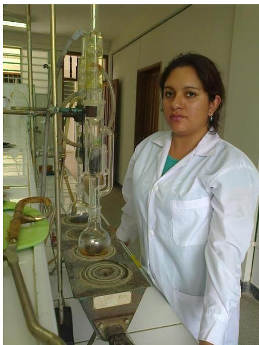
Figura 24. Extracción de alcohol – benceno de las muestras de aserrín
