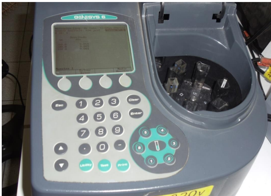
Figura 26. Espectrofotómetro Spectronic 60 usado para medir las absorbancias UV a 260, 280 y 320 nm de las muestras de ADN.
