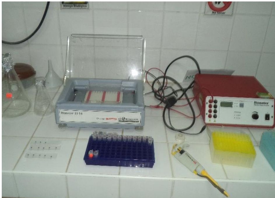
Figura 28. Cámara de electroforesis Whatman Biometra utilizada para la separación de ácidos nucleicos en geles de agarosa.
