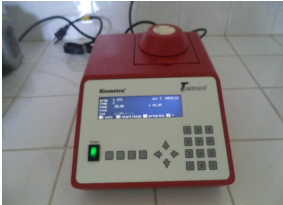
Figura 27. Termociclador Whatman Biometra utilizada para la amplificación de las muestras de ADN.
