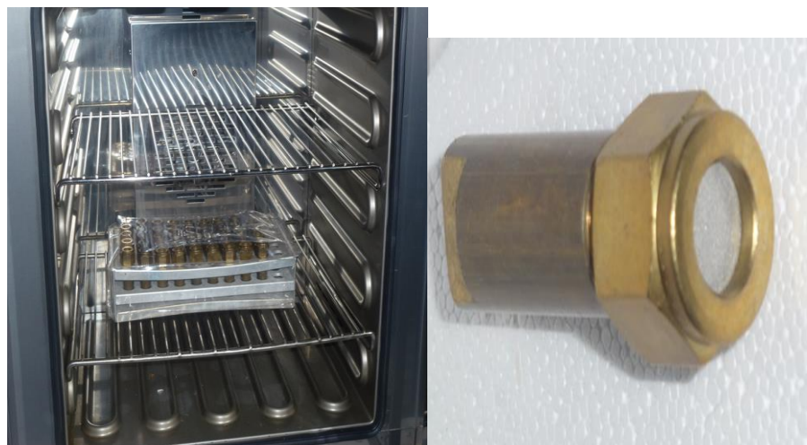
Figura 2. Calibración de tubos de permeación de hexafluoruro de azufre ( SF_6 ).
