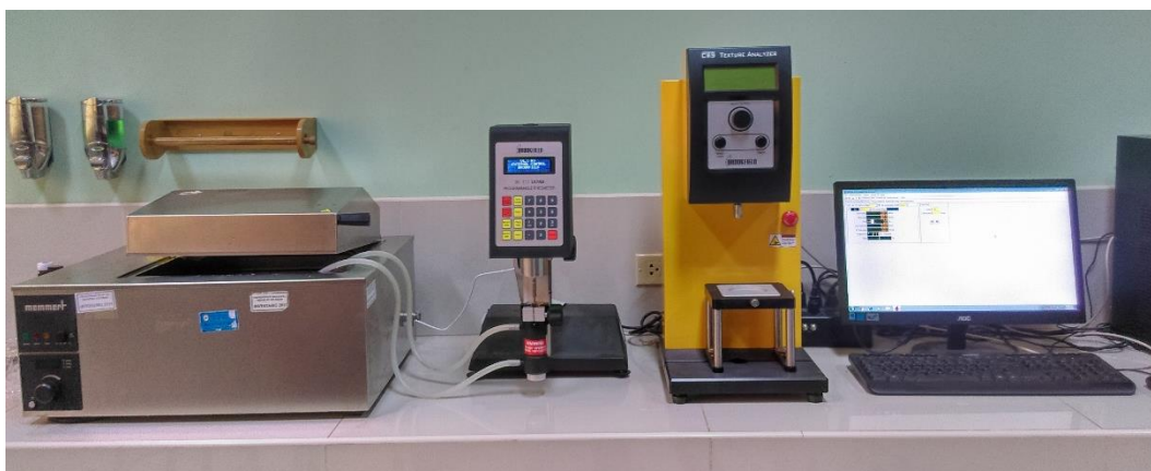
Viscosímetro Brookfield® RVDV III Ultra con el adaptador UL, previo a la prueba de
