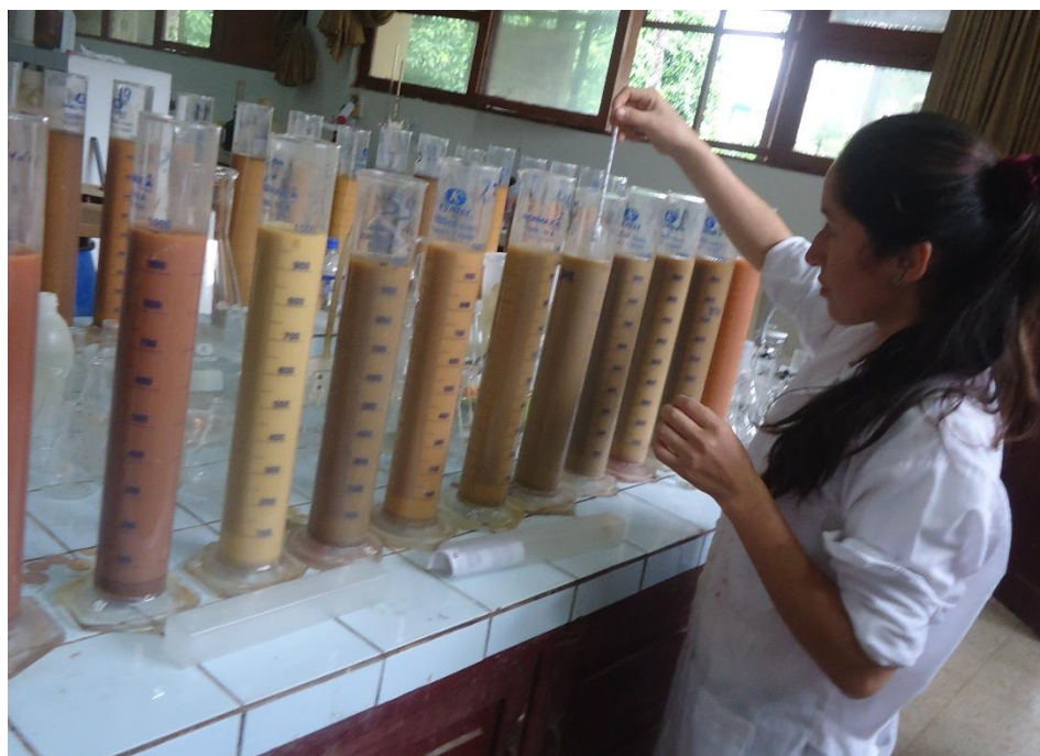
Figura 37. Análisis textural del suelo método Bouyoucos.
