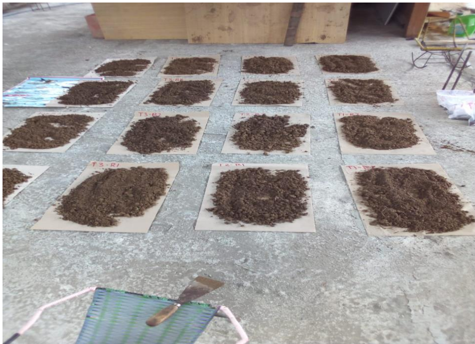
Figura 09. Preparación de muestras de suelo para análisis microbiológico
