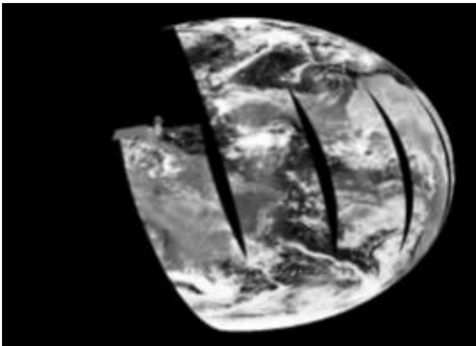
Figura 6. Sistema de escaneo del sensor MODIS. Fuente: Imagen tomada de http://sos.noaa.gov/images/atmosphere/aqua_swath . jpg .
