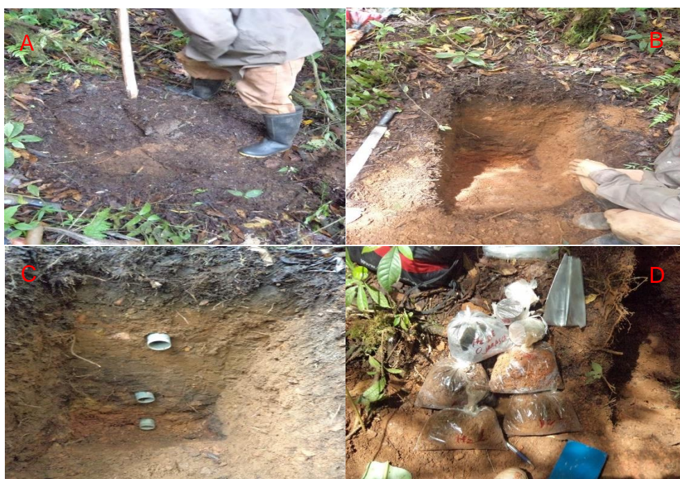
Figura 36. Suelo de cobertura de bosque, A: Excavación de la calicata, B: Calicata culminada, C: Visualización de los horizontes, D: Muestras listas para laboratorio.
