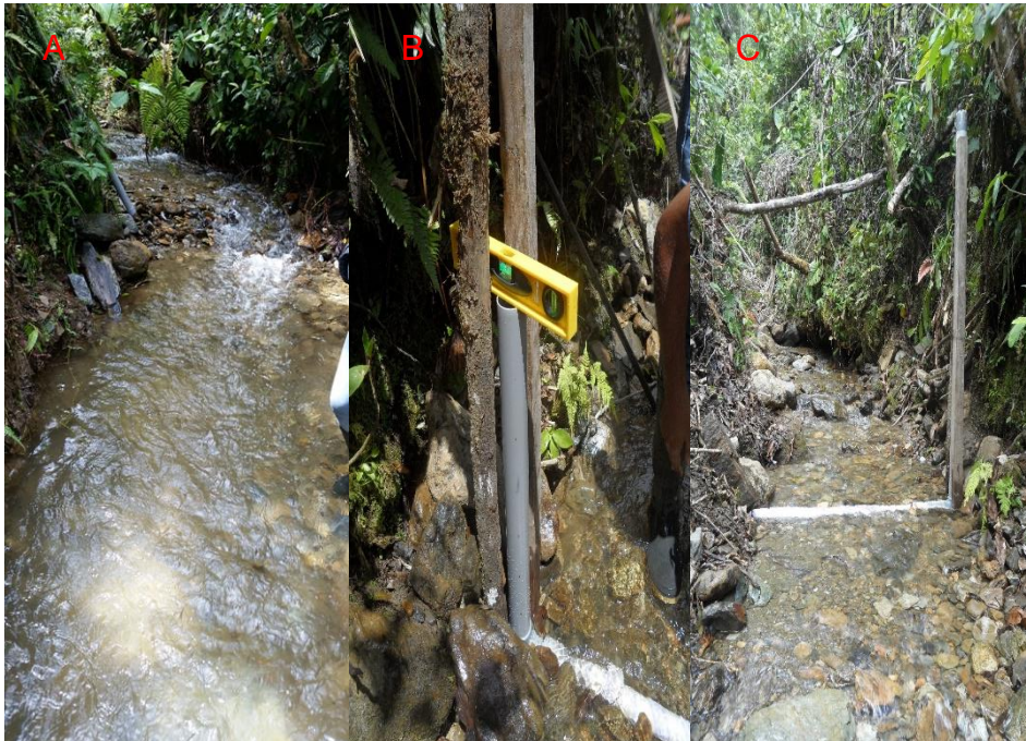
Figura 34. Zona de aforo en la cuenca: A (Quebrada challana), B (Instalación y nivelación del equipo), C (Equipo instalado)
