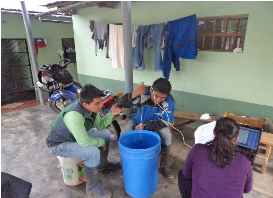
Figura 33. Calibración del sensor de nivel de agua ODISEY
