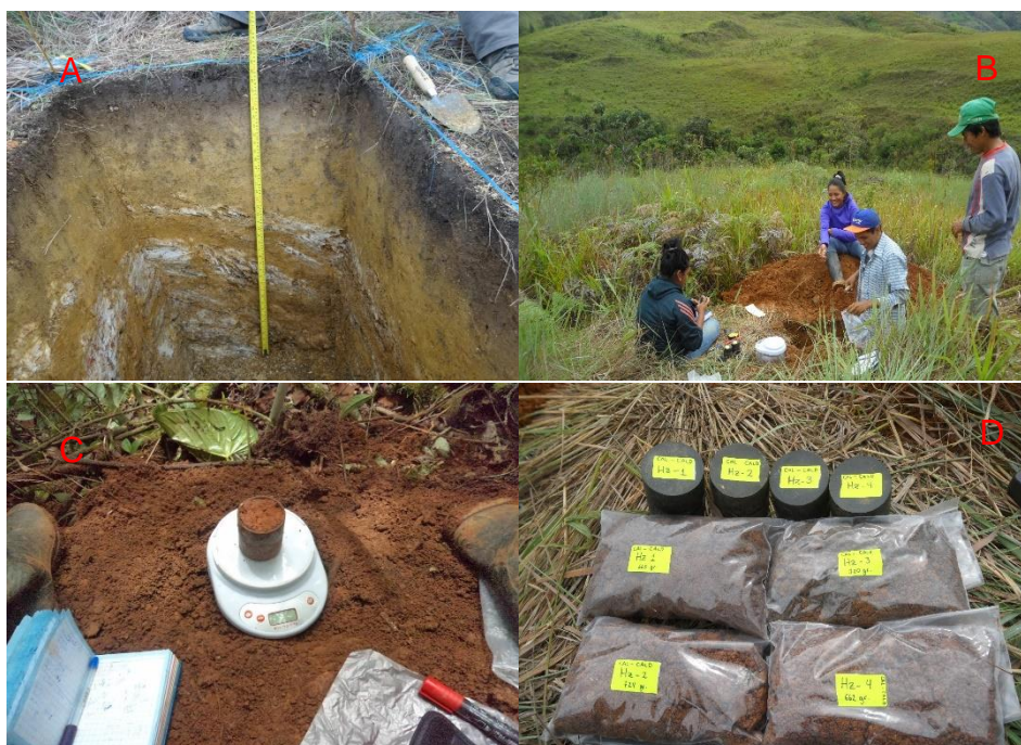
Figura 38. Tomas de muestras: A (Medida de los horizontes), B (Toma de muestra de cada horizonte), C (Pesado natural), D (Etiquetado).
