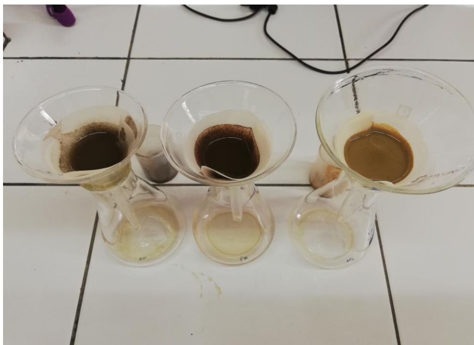
Figura 30. Filtración de las muestras después de la centrifugación
