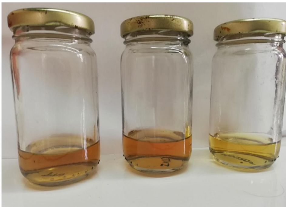
Figura 31. Extracto de las muestras para su análisis de contenido de cadmio en el espectrofotómetro de absorción atómica
