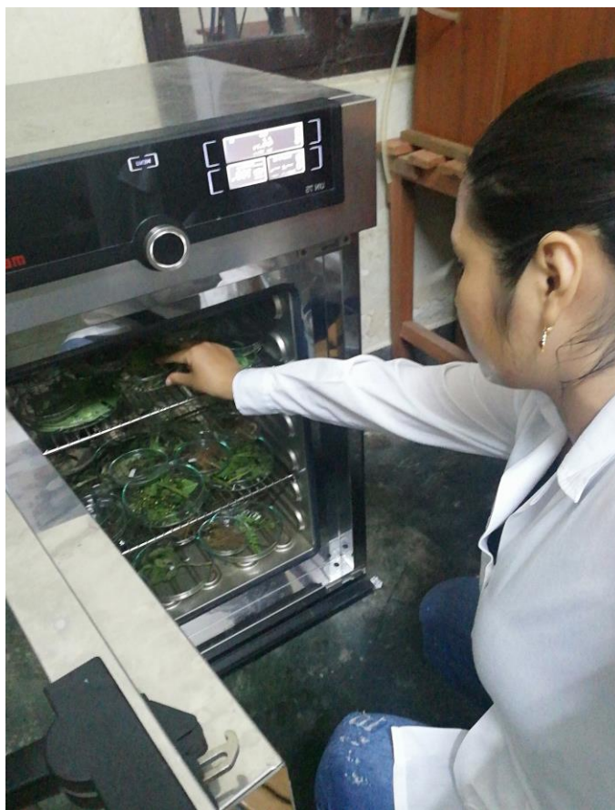
Figura 35. Secado en la estufa para el peso en seco de las especies vegetales
