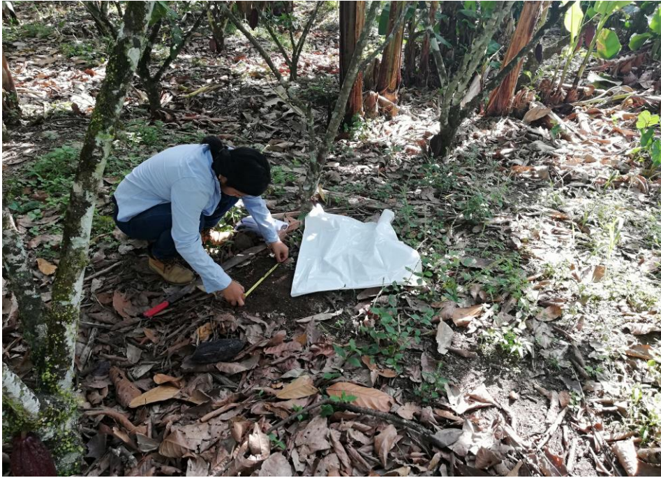
Figura 25. Medición para realizar la calicata para muestreo de suelo
