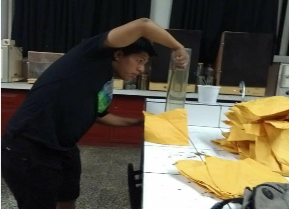
Figura 17. Medición del volumen de la muestra del árbol
