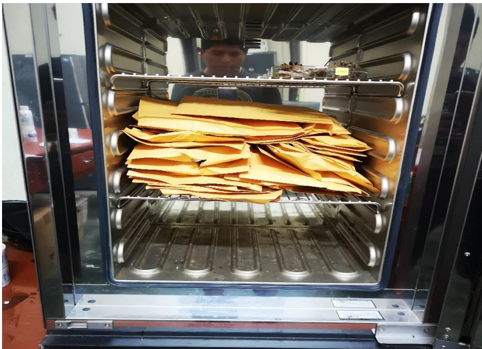
Figura 24. Secado de las muestras de especies arbóreas en la estufa
