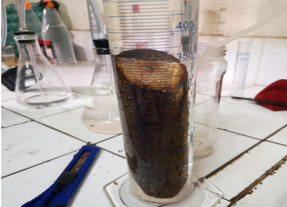
Figura 23. Determinación del volumen de la muestra de la especie arbórea
