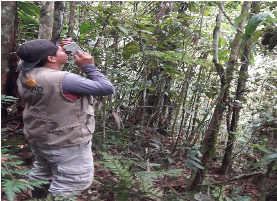
Figura 14. Medición control de la altura de los árboles con el clinómetro
