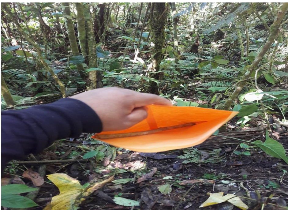
Figura 16. Obtención de muestra cilíndrica para obtener la densidad básica
