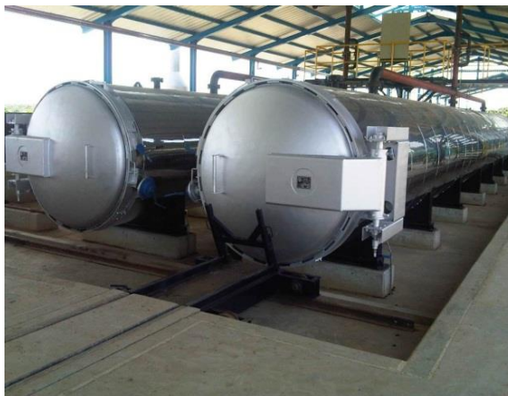
Figura 7. Esterilización de racimos de palma aceitera.
