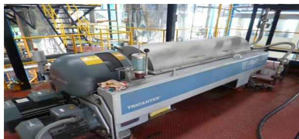
Figura 14. Tricanter utilizado para clarificación de aceite crudo de palma.
