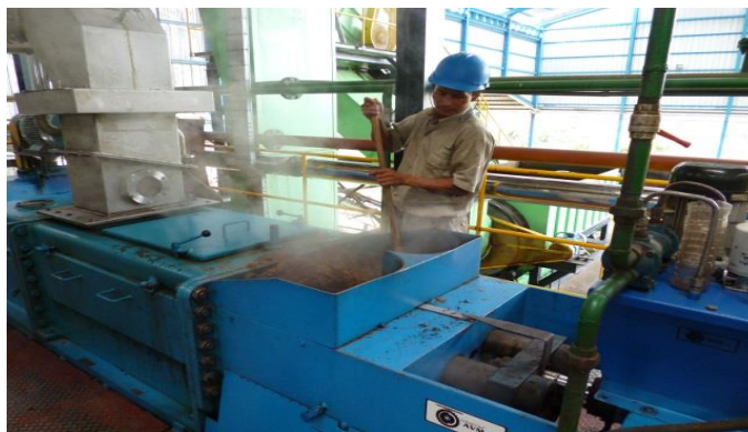
Figura 10. Prensado de frutos de palma para obtener aceite.
