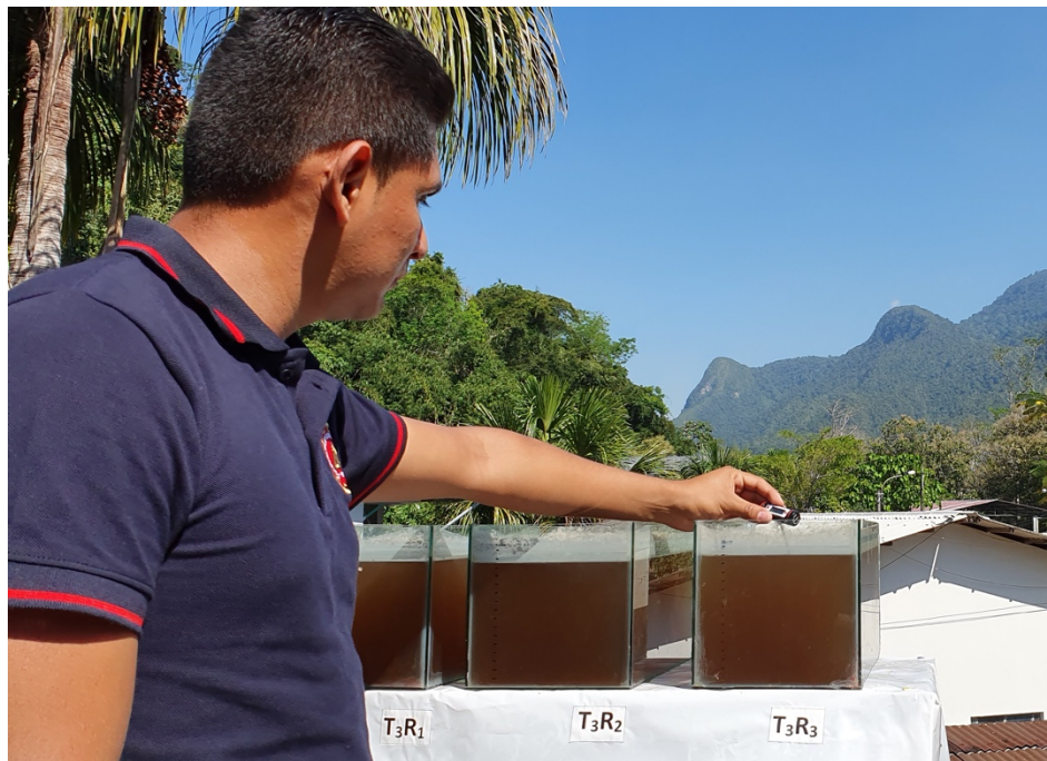
Figura 19. Medición de la variación del pH ante la exposición a la radiación.
