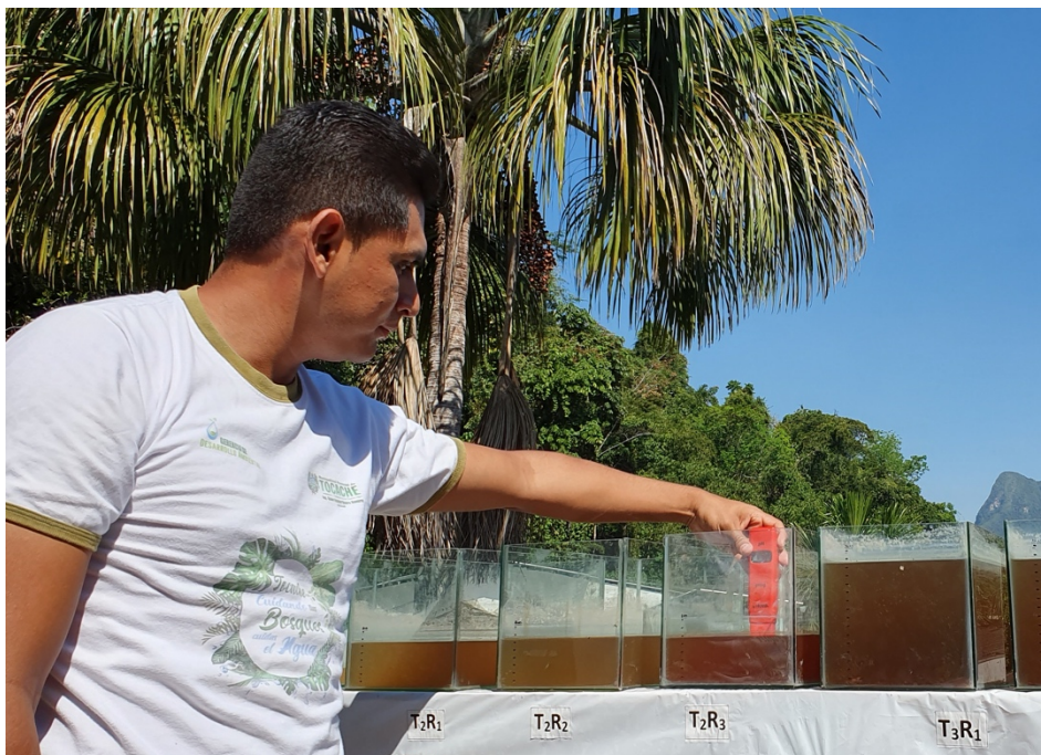
Figura 18. Medición de la variación de la temperatura ante la exposición a la radiación.
