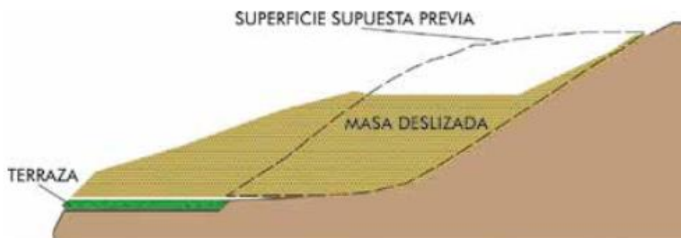
Figura 15. Proceso de deslizamiento de masas
