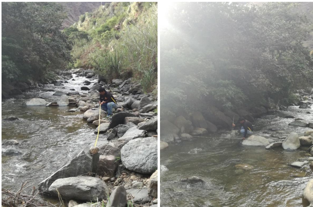
Figura 41. Determinación de caudal del río garbanza por el método de flotador a 1850 msnm.
