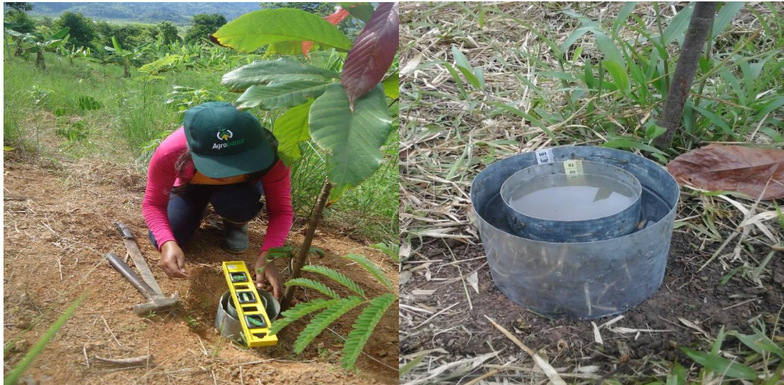
Figura 21. Instalación de los cilindros y evaluación de la infiltración
