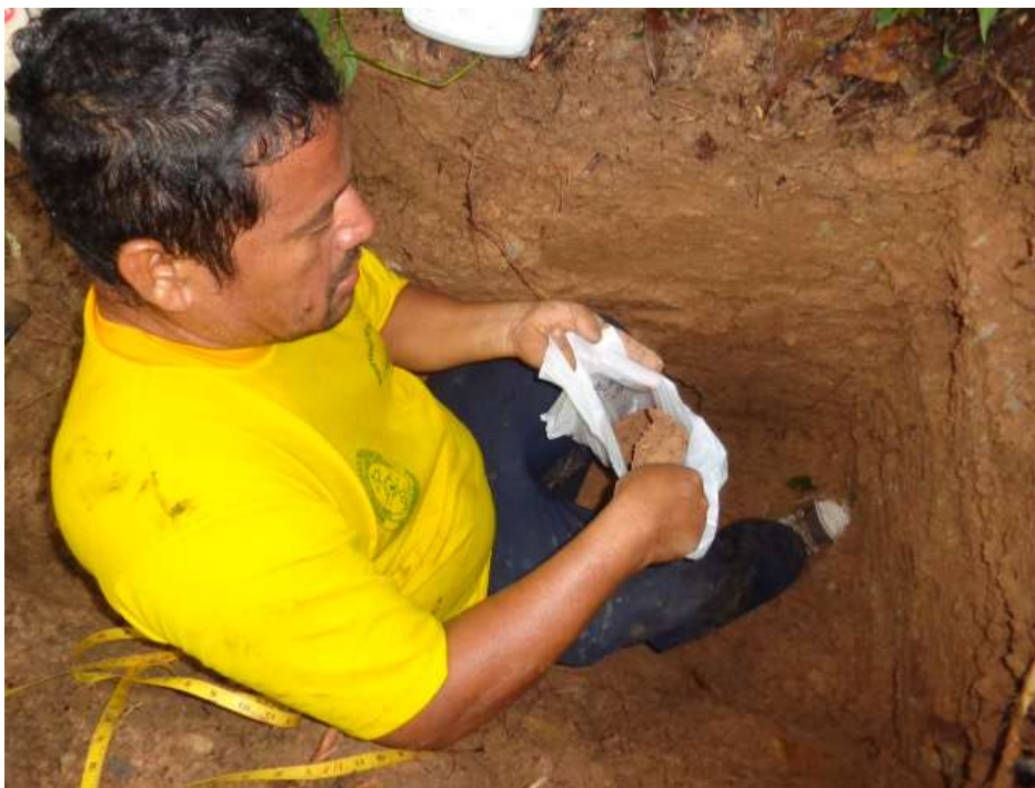
Figura 18. Muestreo de suelo para determinación de carbono.
