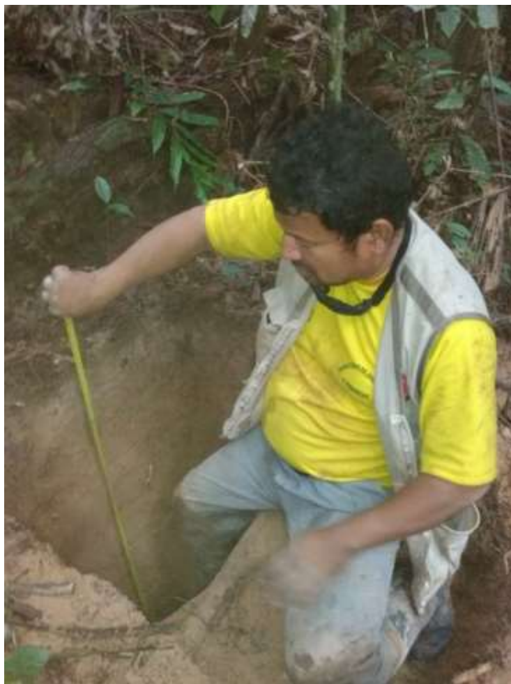
Figura 12. Determinando las capas de muestreo en la calicata.
