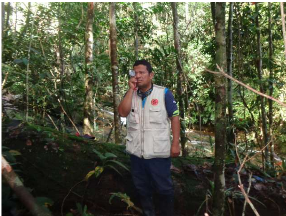
Figura 4. Determinando las pendientes con la ayuda de un eclímetro.
