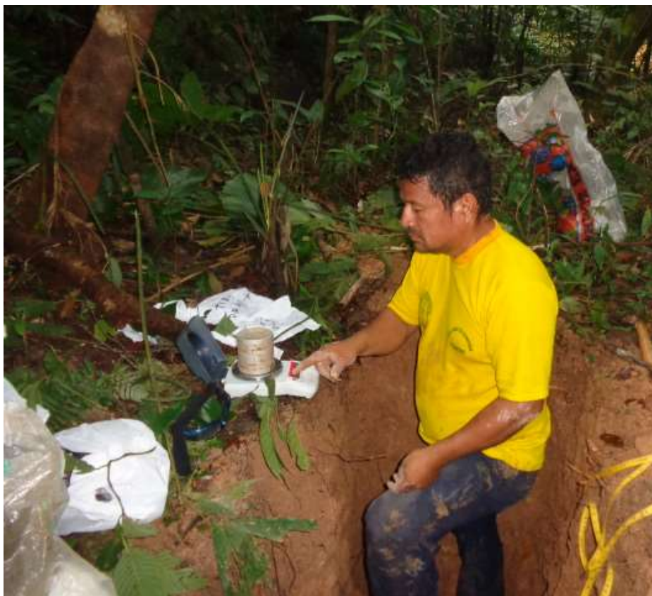
Figura 16. Determinando el peso húmedo de la muestra.
