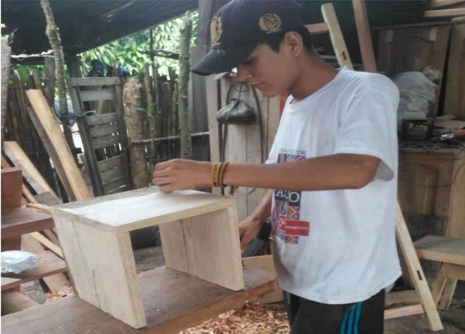
**Figura 10.** Fabricación de un cuadrado de 25 x 25 cm de ancho y 30 cm de profundidad.
