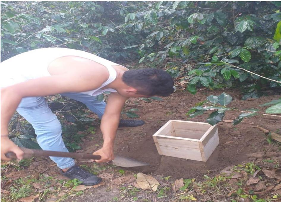
**Figura 11.** Excavación del exterior de monolito para el muestreo.
