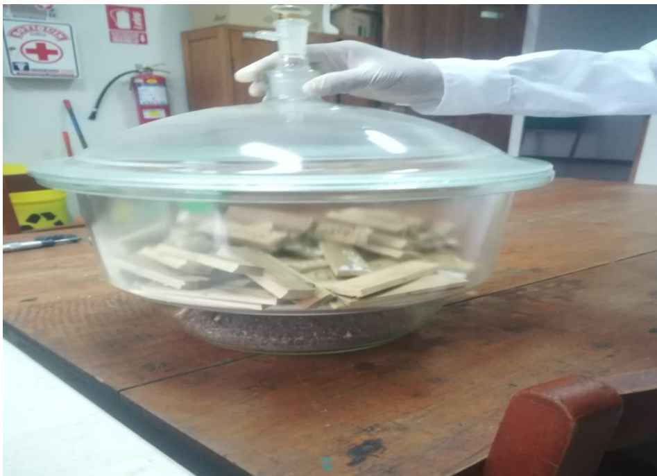
Figura 24. Probetas retiradas y puestas al desecador
