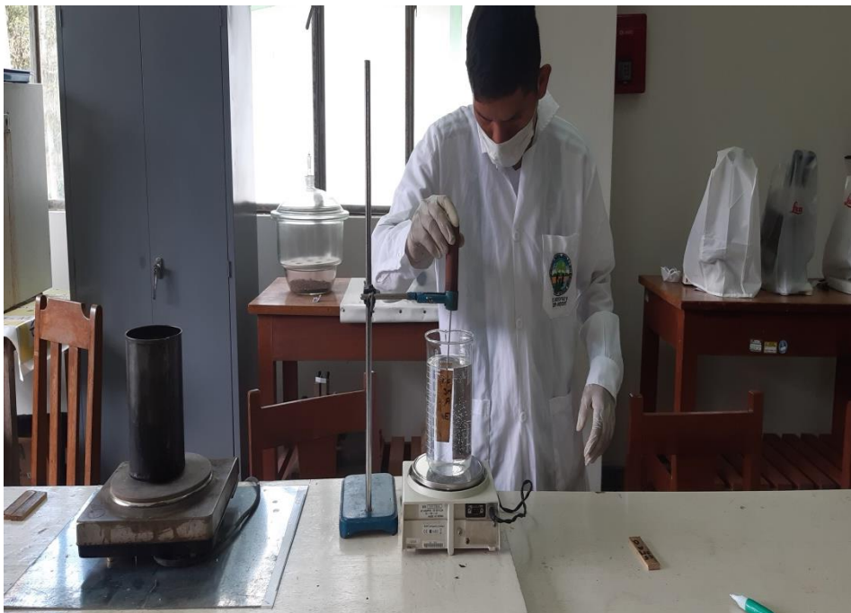
Figura 26. Principio de Arquímedes después de la estufa
