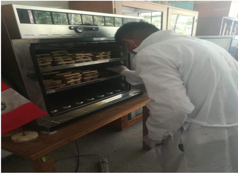
Figura 23. Probetas colocadas a la estufa
