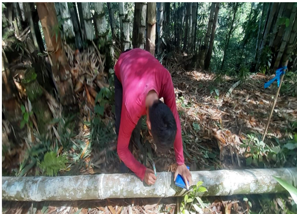
Figura 190. Seccionado de los culmos para los tres niveles
