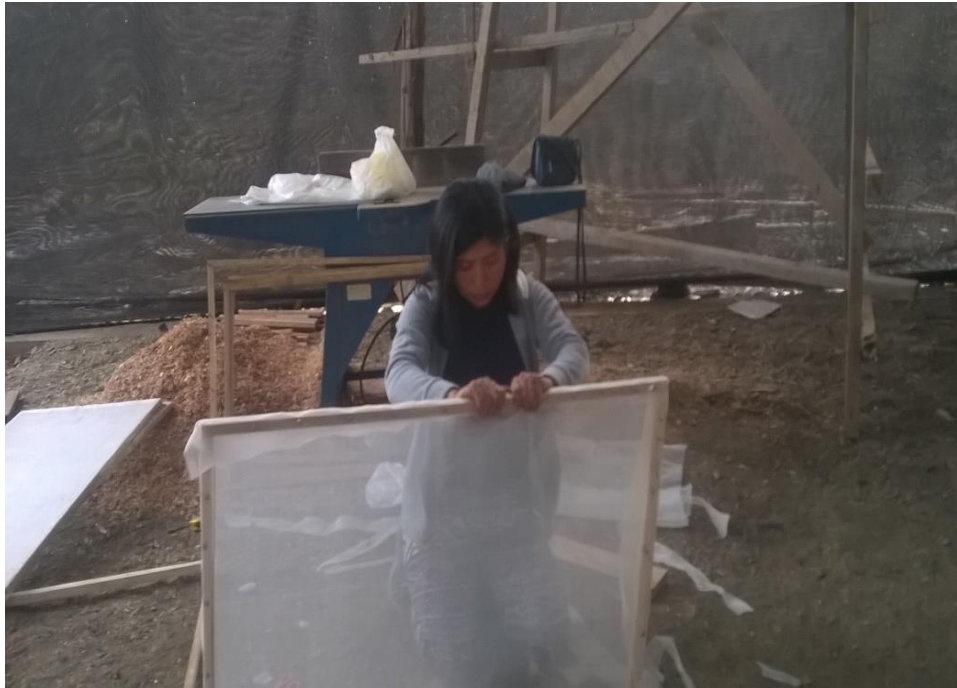
Figura 36. Colocado de la Malla agro film a las parrillas del secador de hongos.
