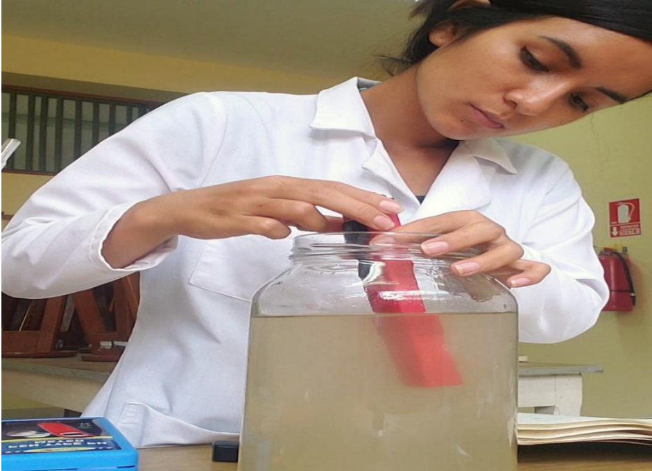
Figura 41. Toma del pH de una muestra de agua del río Huallaga, para realizar la validación del modelo de superficie de respuesta.
