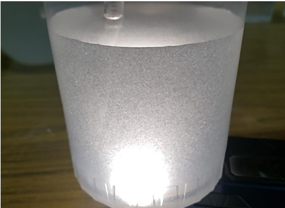
Figura 38. Formación de flóculos después de agrega las dosis óptimas de sulfato de aluminio y A. vera como floculante natural.
