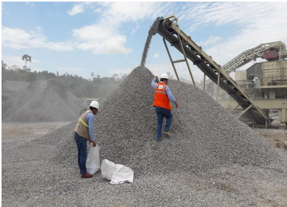
Figura 32. Muestreo de Agregado - Filtro Para Sub Dren
