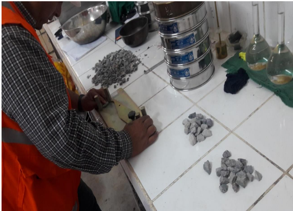
Figura 34. Ensayo de Caras Fracturadas para Agregados de Piedra Chancada para Concreto y Filtro Para Sub Drenes.
