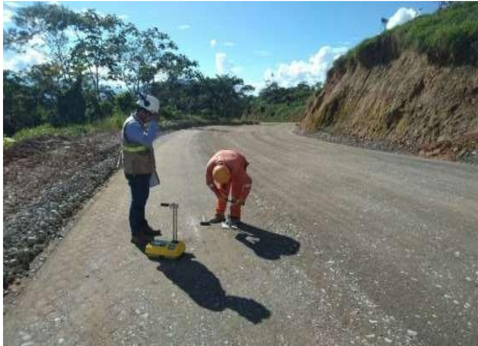
Figura 15. Ensayo de densidades por el metodo de densímetro nuclear
