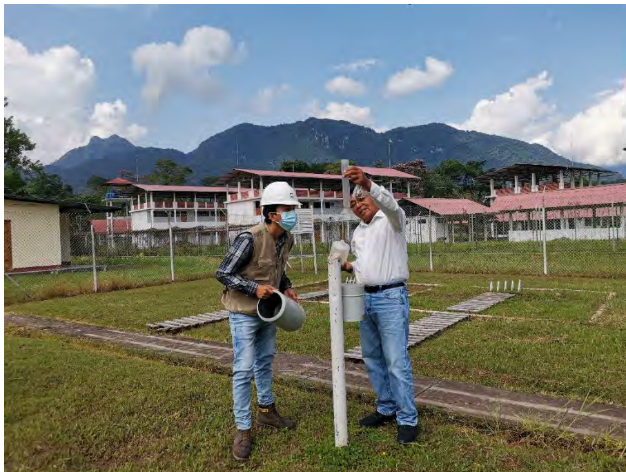
Figura 49. Medición de precipitación acumulada en el pluviómetro.
