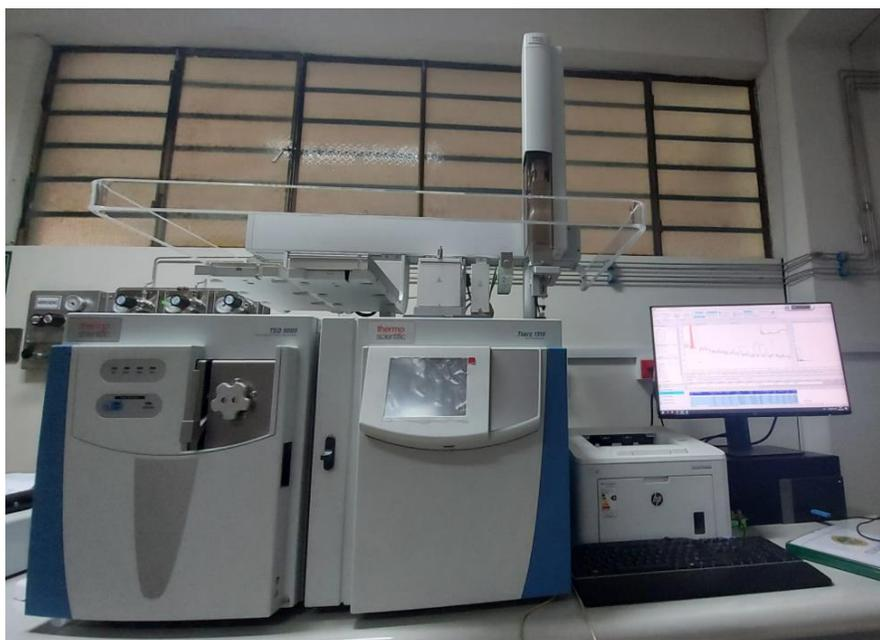
**Figura 30.** Equipo acoplado GC-MS utilizado (Lab. de Fitoquímica, Facultad de RNR, UNAS)
