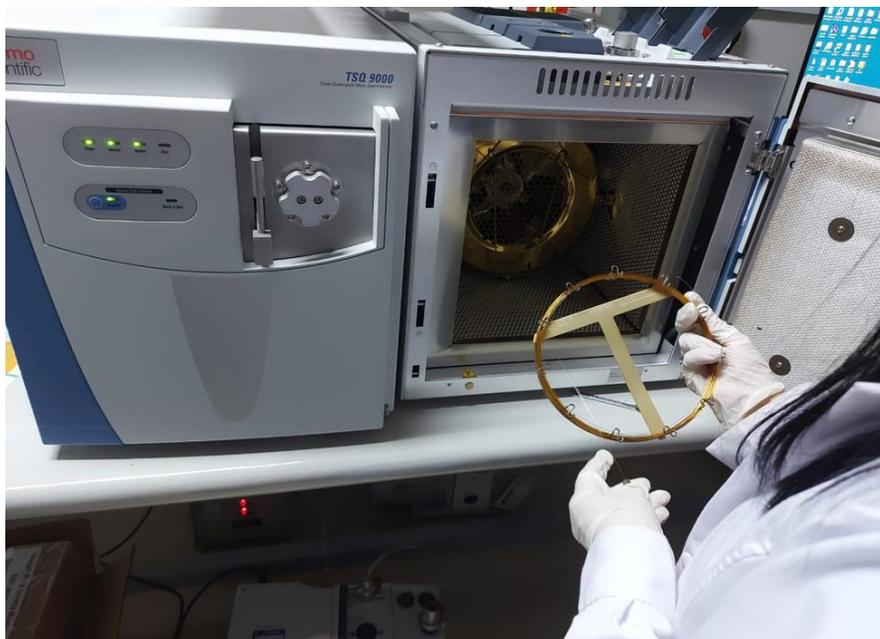
**Figura 29.** Columna capilar TG-5SILMS usada (30 m x 0,25 mm de d.i., 0.25  $\mu$ m)
