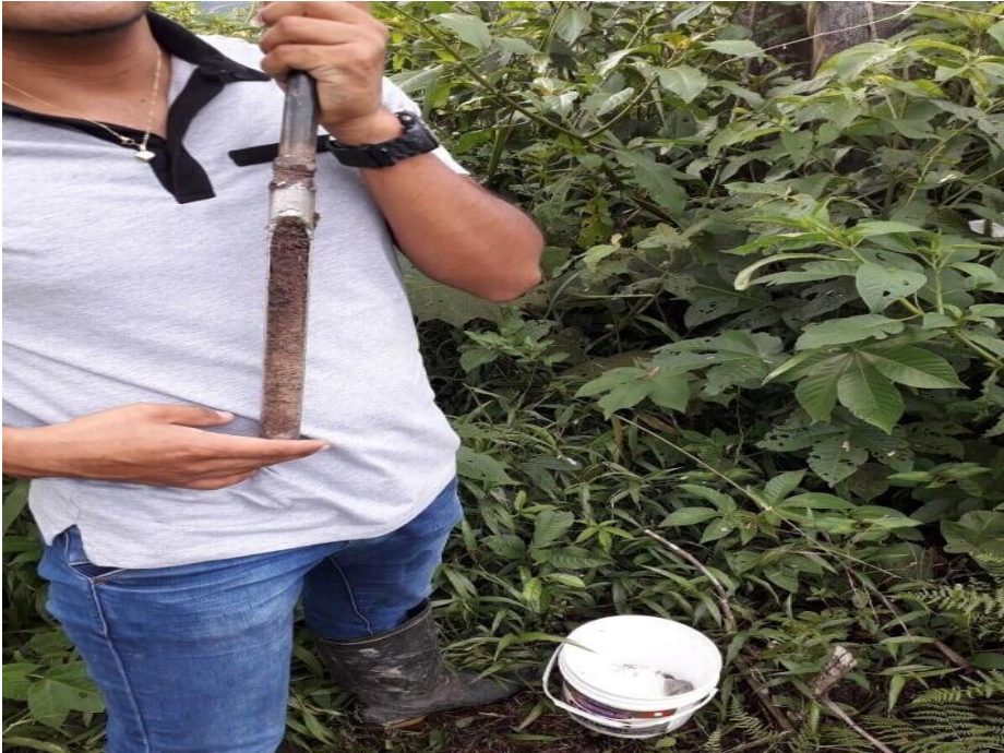
Figura 24. Muestras de suelo extraído con el barreno antes de la limpieza de la parcela
