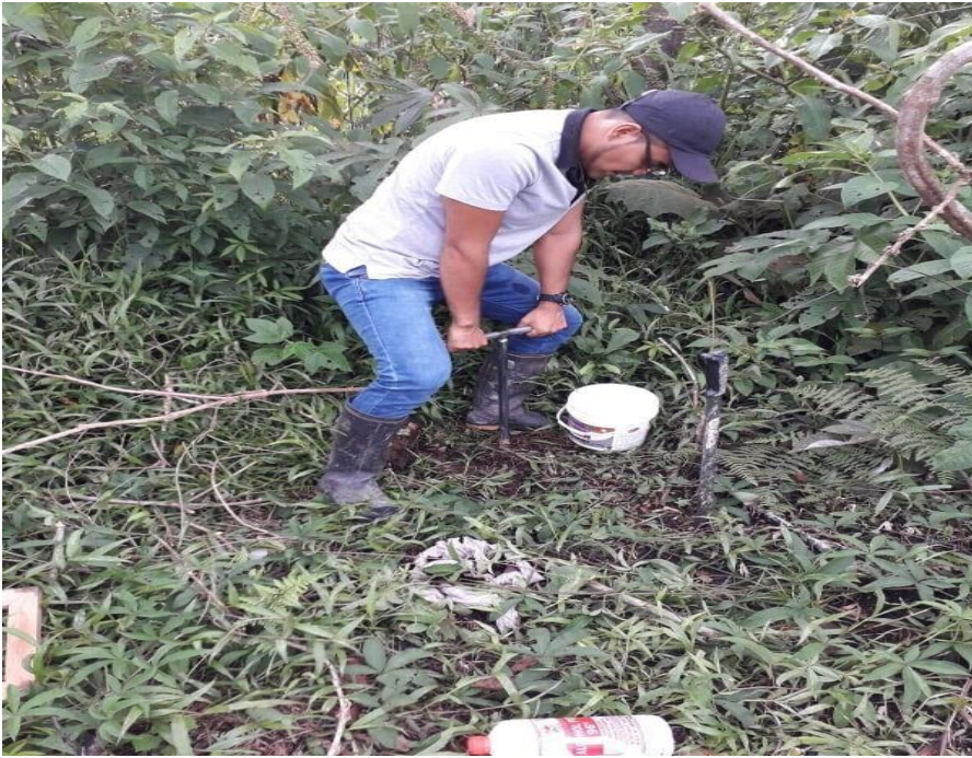
Figura 22. Muestreo de suelo de la parcela con barreno
