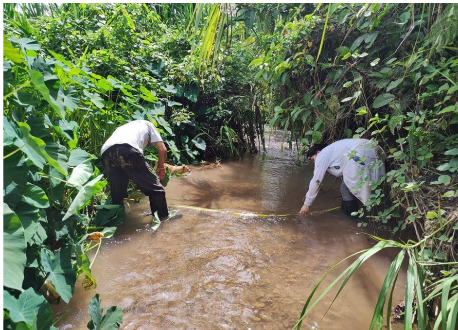
Figura 24. Medición de áreas para la obtención del caudal del punto 3 de muestro en la quebrada Agua Blanca.
