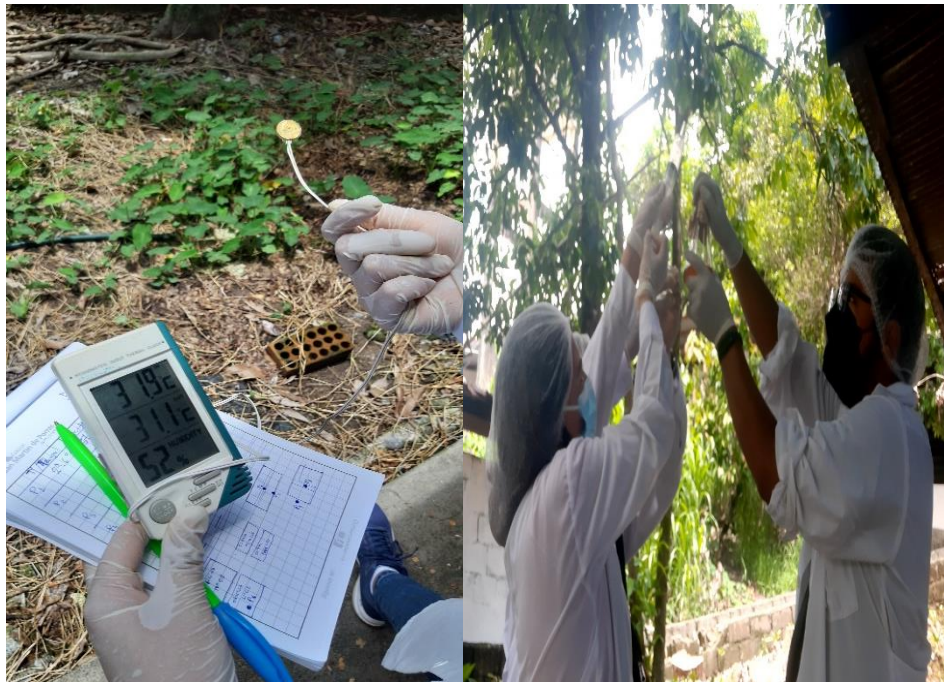
Figura 19. Medición de los factores físicos con el Termohigrómetro y toma de muestras en el espacio M2-A (módulo 2 sección A)
