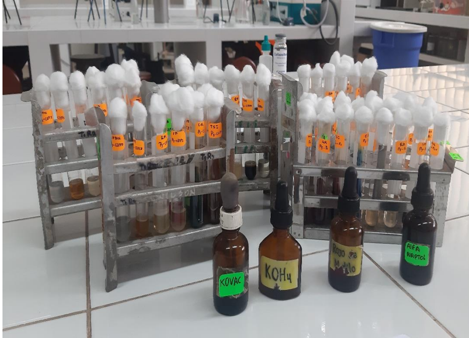
Figura 37. Sacando los tubos de ensayo de la incubadora después de 48 horas para adicionar sus respectivos reactivos
