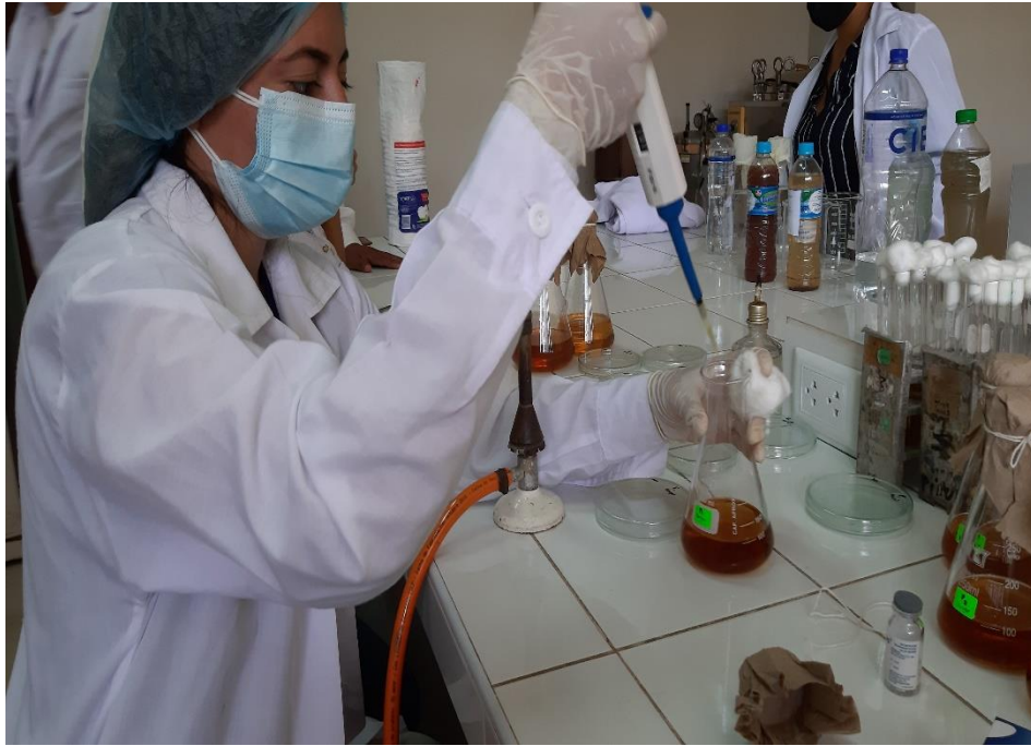
Figura 23. Se sacó 1 ml de la muestra tomada en campo
