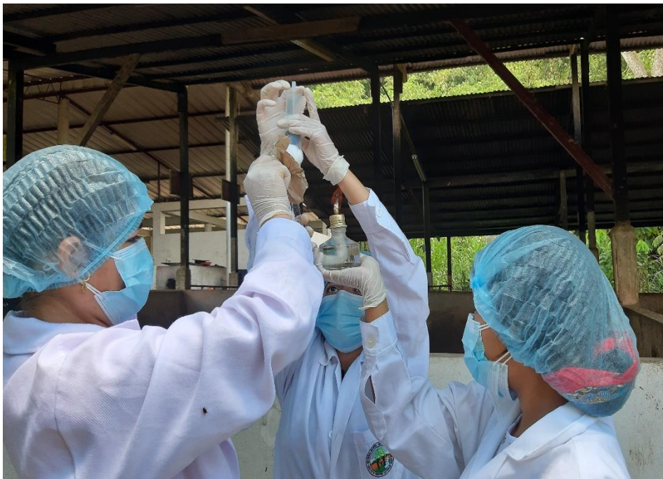
Figura 18. Toma de muestra de aire en el espacio M1-B (módulo 1 sección B)
