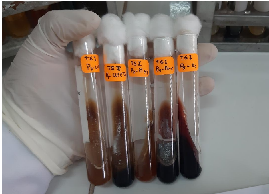
Figura 45. Tubos con medio TSI con presencia de gas y presencia de H 2 S en los espacios M1-A, M2-B y “O”
