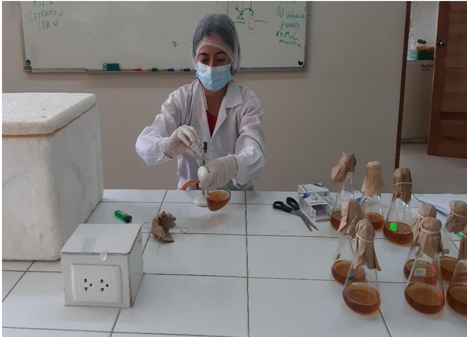
Figura 16. Colocando antibiótico Ceftriaxona a los matraces para fungi
