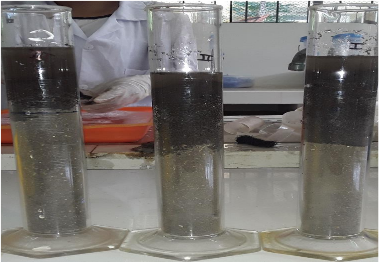
Figura 17. Determinación de cadmio en el suelo.
