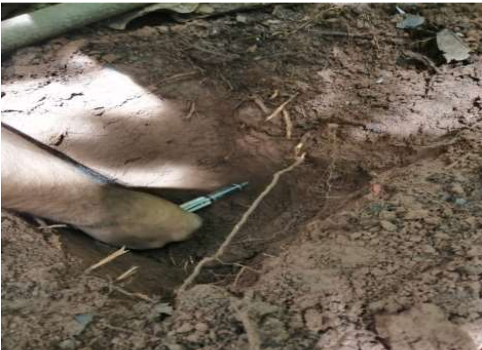
Figura 8. Golpes para medir R_p con el penetrómetro.
