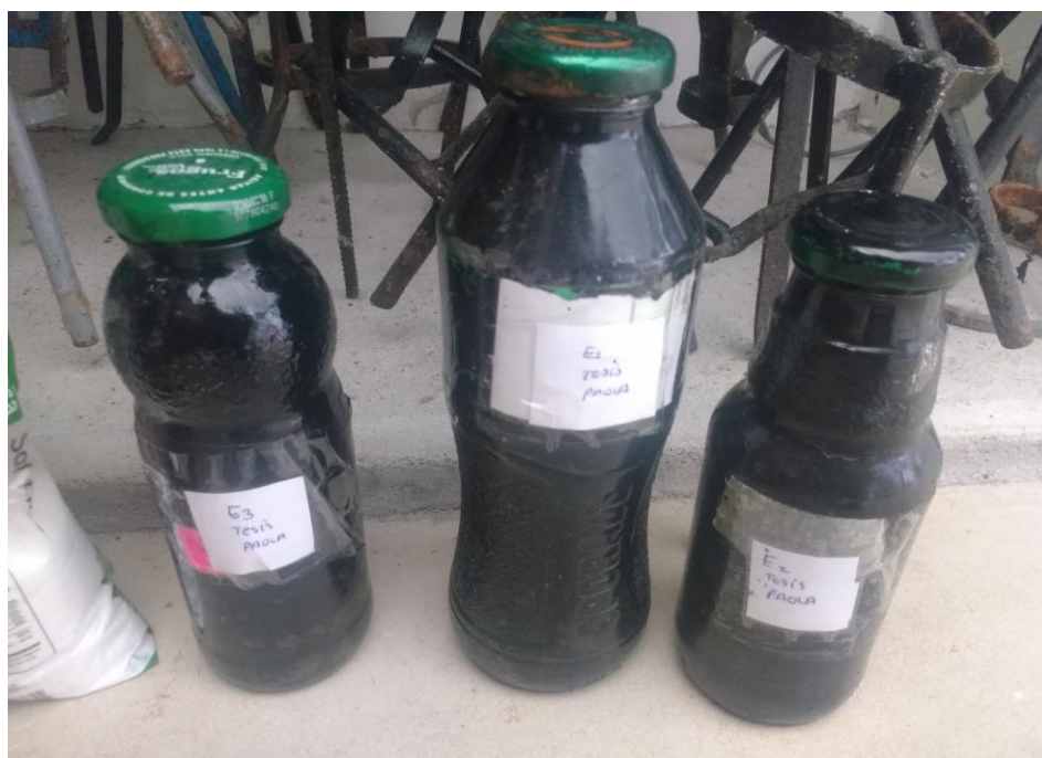
Figura 64. Degradación con H_2O_2 de las muestras de agua de las tres estaciones de muestreo.
