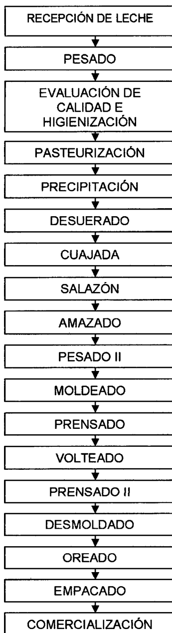
Figura 3. Diagrama de flujo general del proceso de elaboración del queso Ucayalino en la planta lechera de la UNU. Acondicionado de: (ORDOÑES, 2005) y (PULGAR, 1974).
