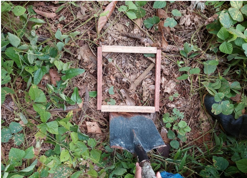
Figura 18. Limpieza y colocación del margen para realizar con la extracción del monolito.
