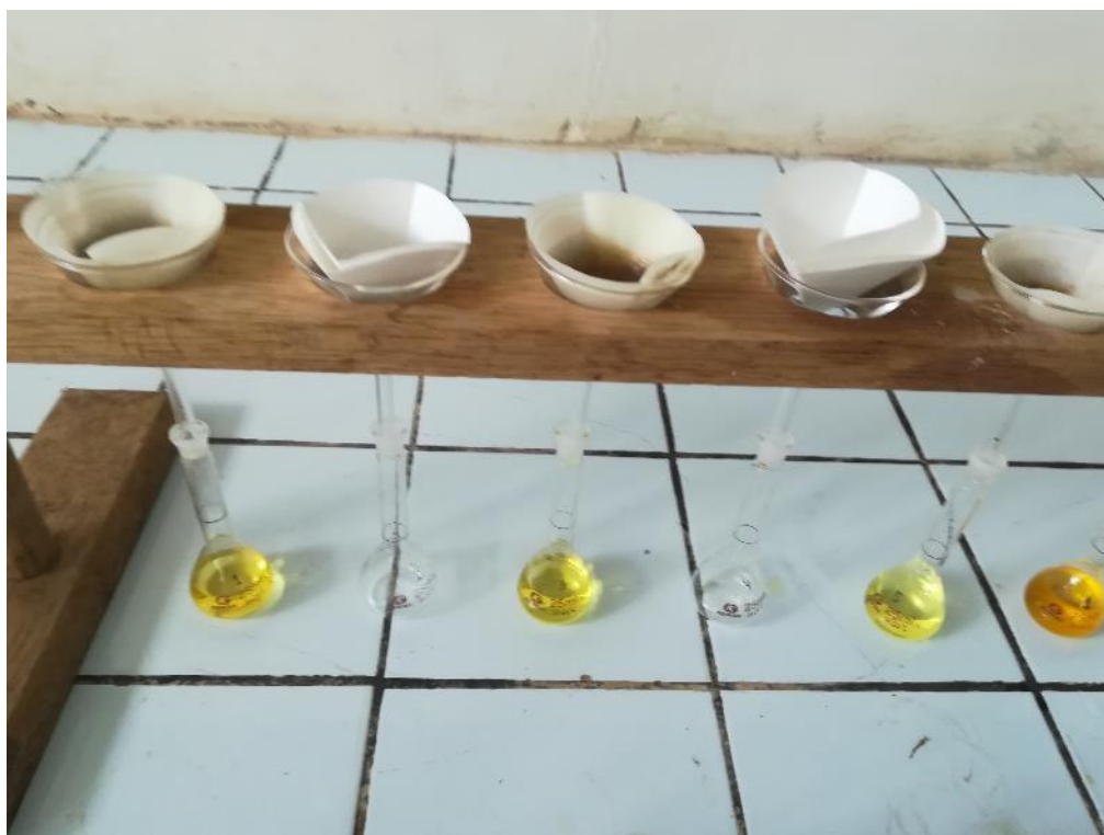
Figura 20. Procedimiento de tamizaje para determinación de materia orgánica.
