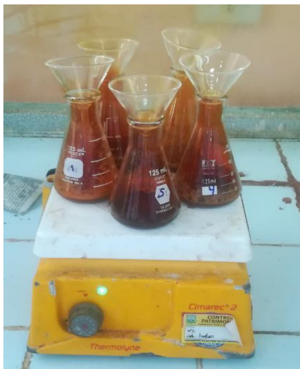
Figura 19. Procedimiento de extracción para determinación de materia orgánica de humus y compost.
