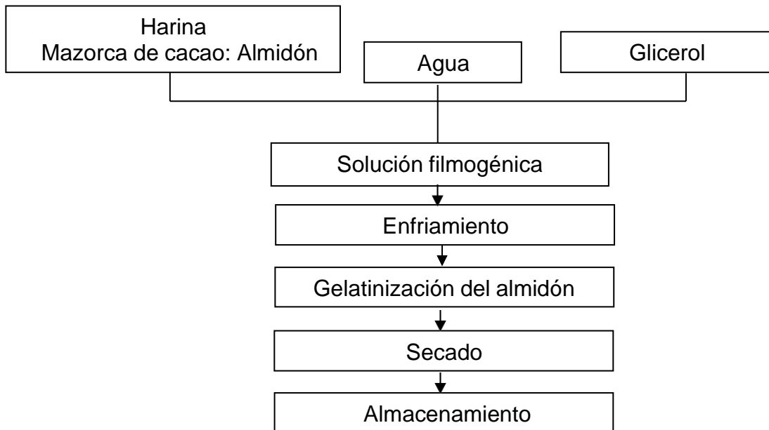
Figura 5. Diagrama de flujo para la obtención de polímeros biodegradables de la mazorca del cacao.
