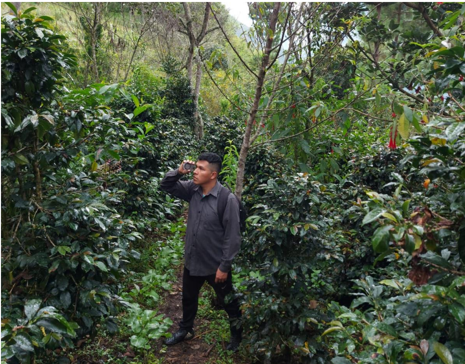
Figura 38. Obtención de pendiente con clinómetro
