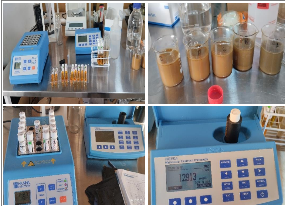
Figura 20. Determinación de la DQO
