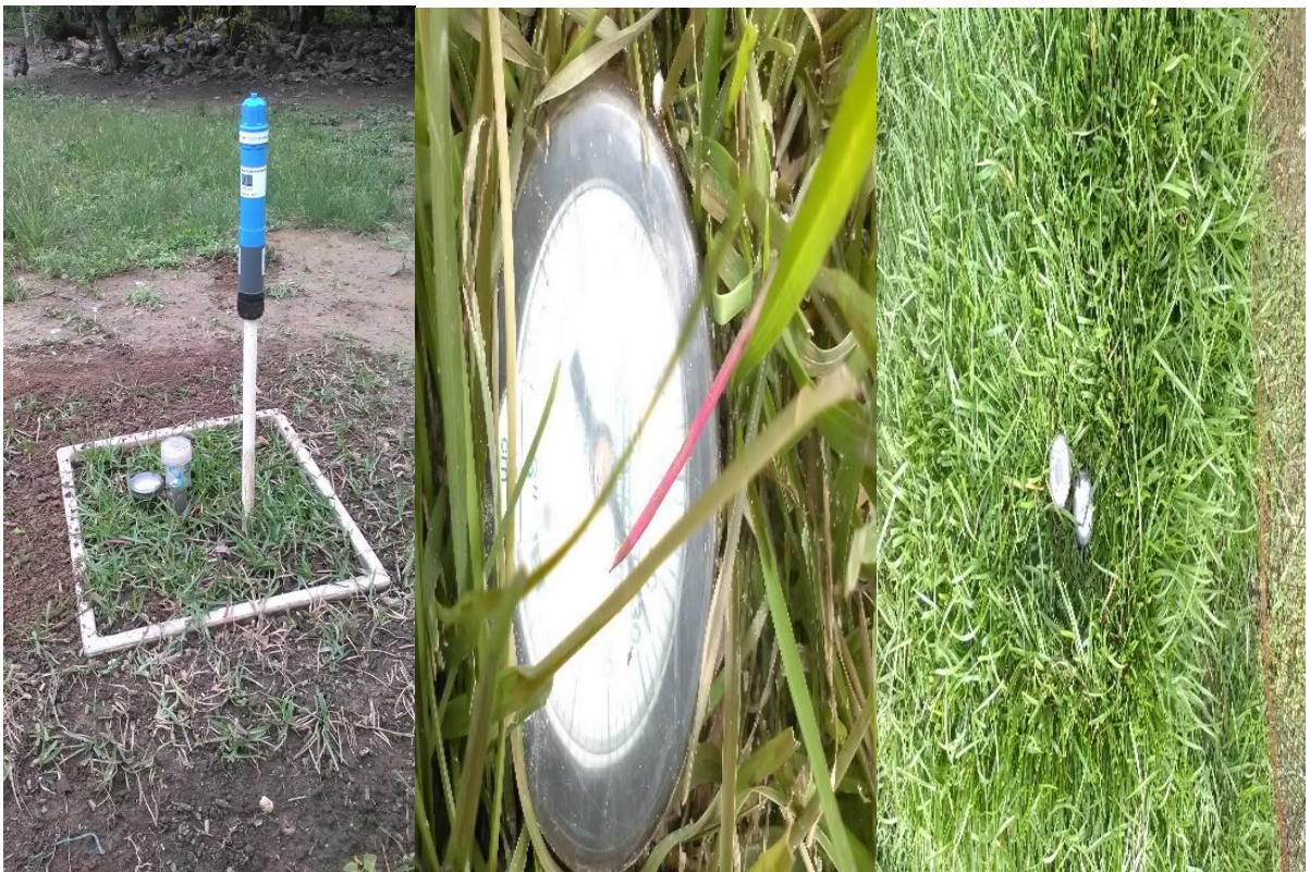
Figura 24. Instalación del tensiómetro Irrometer y lecturas de humedad.
