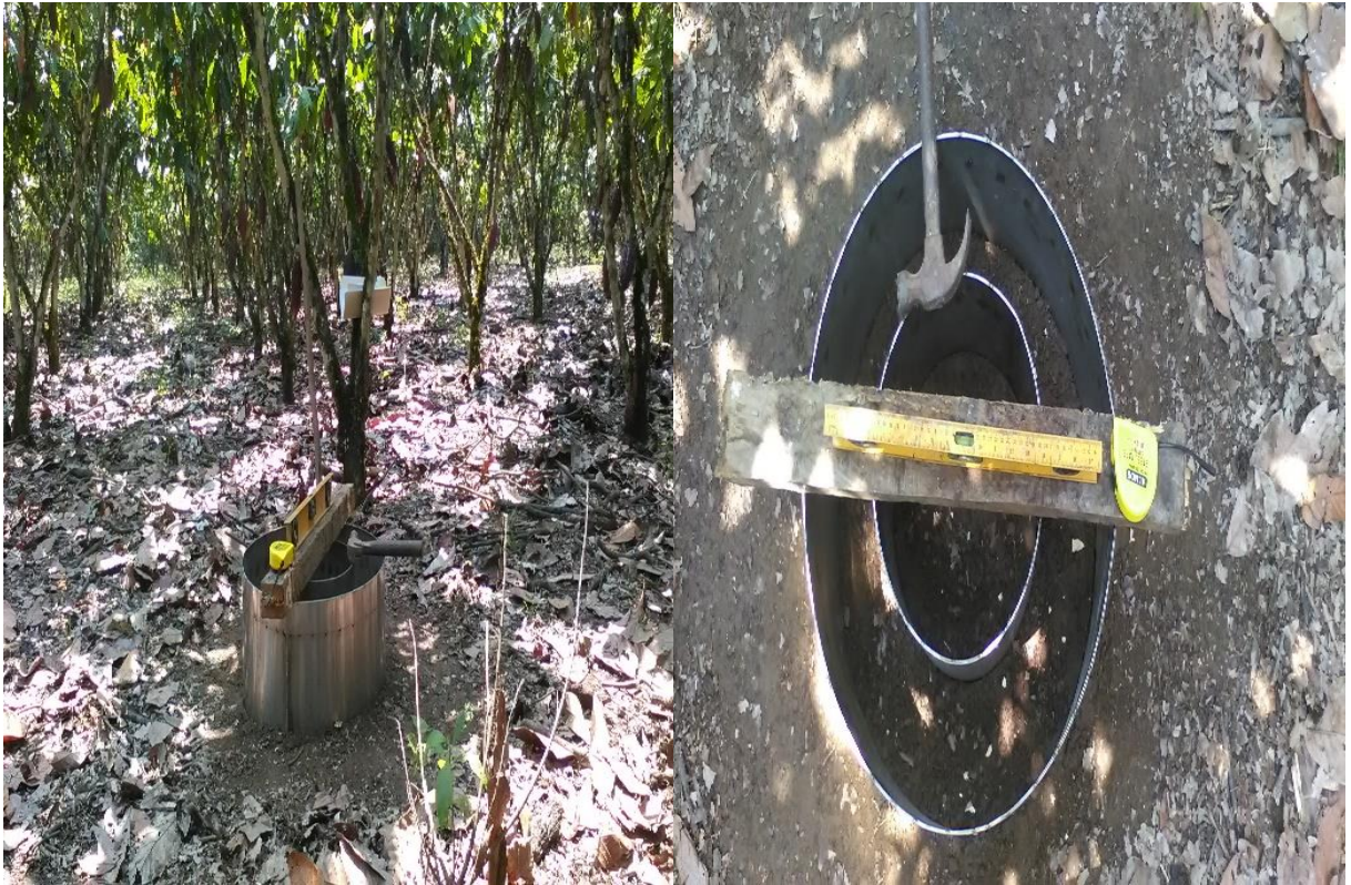
Figura 19. Instalación anillo Infiltrómetro de doble anillo.
