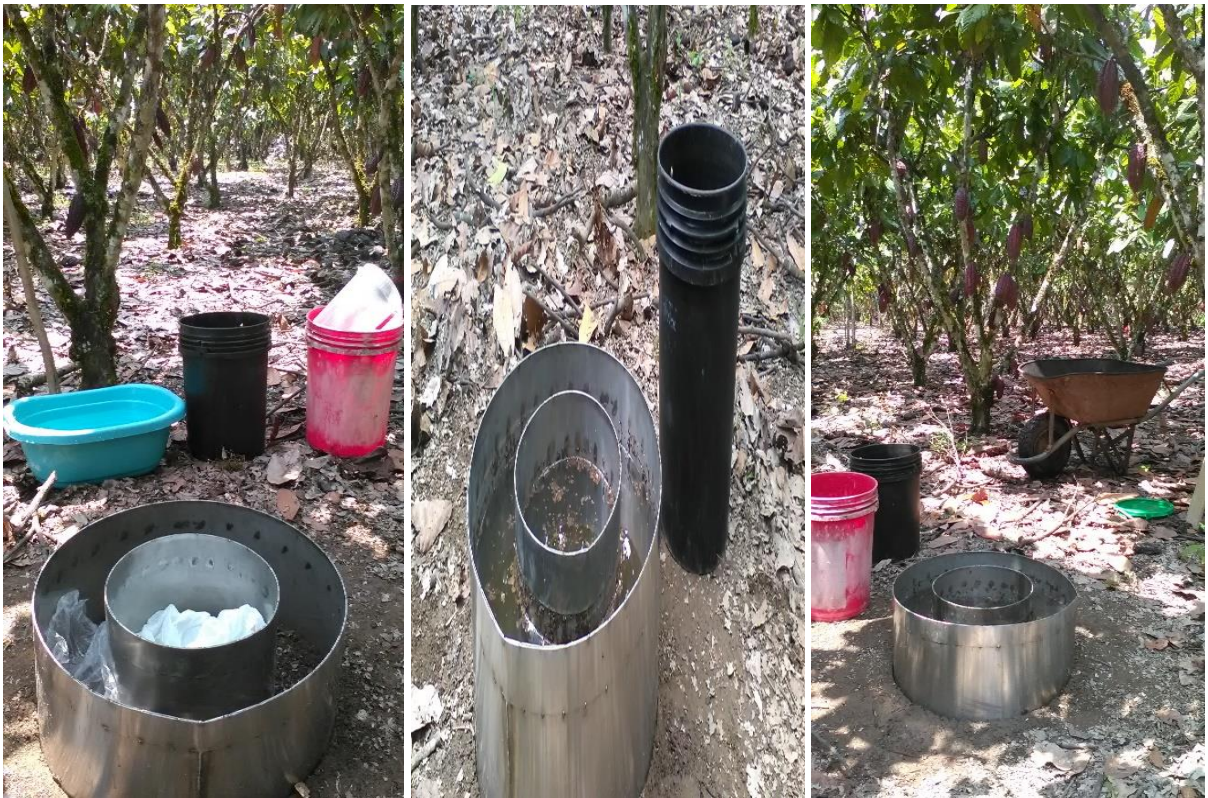
Figura 20. Prueba de infiltración.
