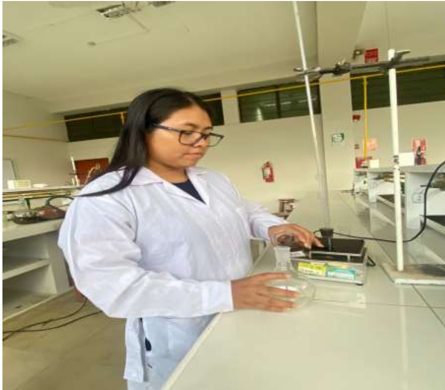
Figura 45. Añadir 10 ml de cloroformo a la muestra para análisis de peróxido
