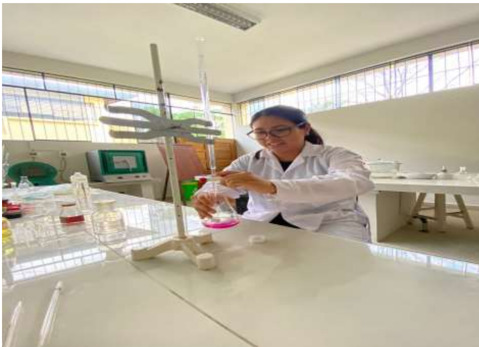
Figura 46. Titulación con tiosulfato de sodio
