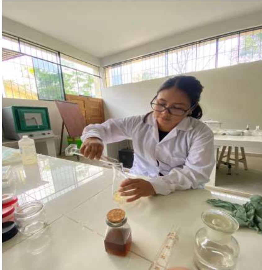
Figura 41. Adición de tetracloruro de carbono para disolver la grasa para análisis de índice de yodo
