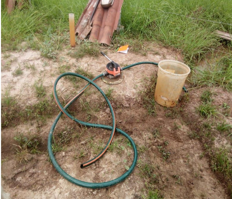
Figura 39. Equipos para sacar el agua de drenaje del lisímetro de drenaje.
