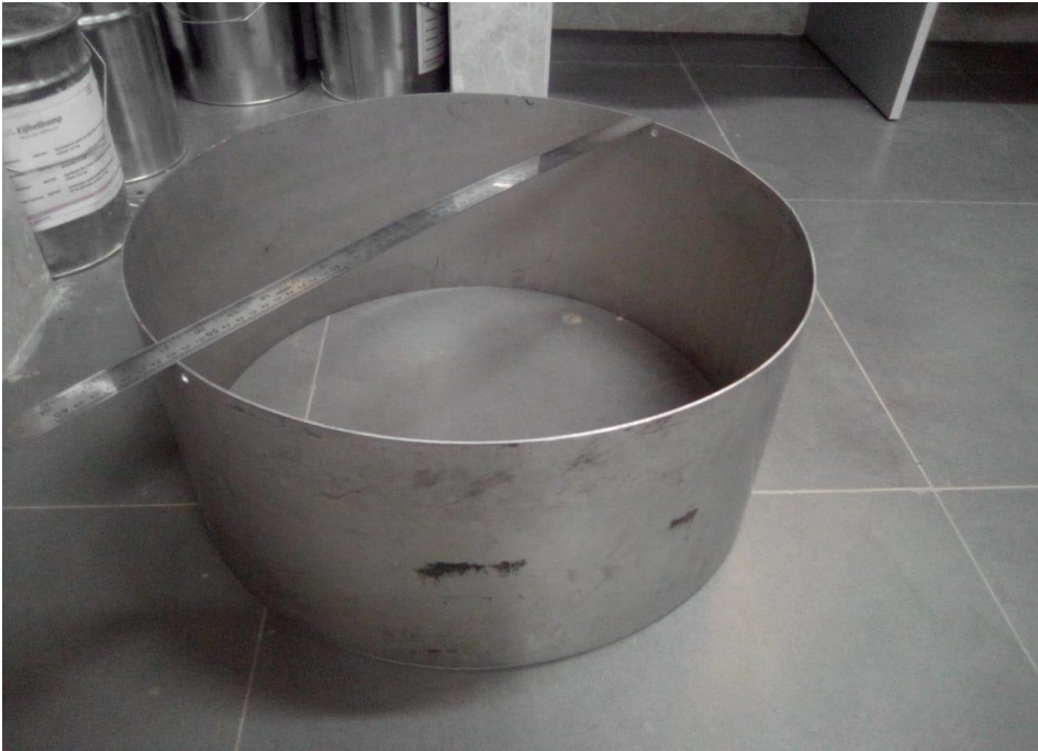
Figura 12. Cilindro de doble anillo externo
