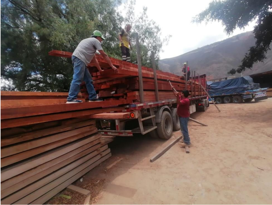
Figura 28. Descarga de madera comercial intervenido usando el polín
